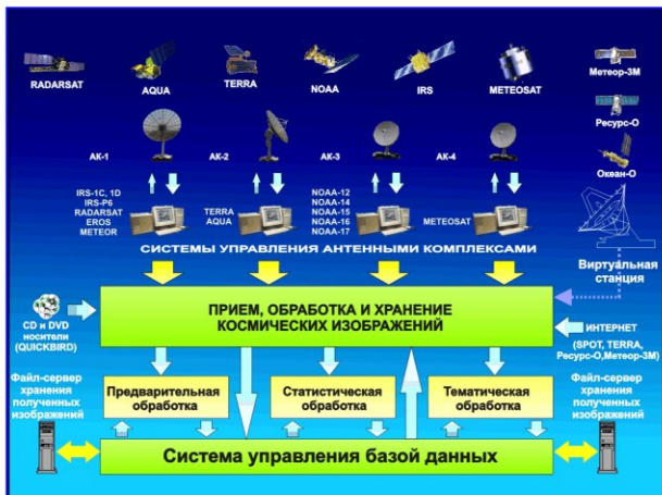
Организация приема, обработки и хранения спутниковых данных в «Аэрокосмос»
