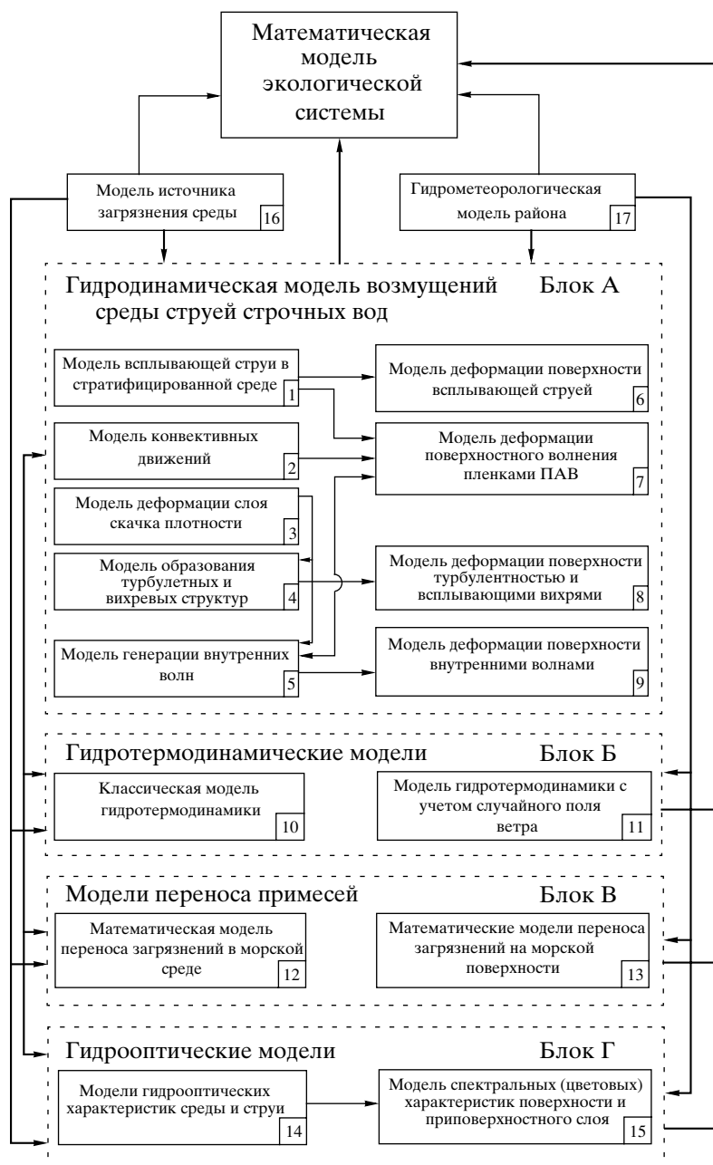
Рис. 1. Блок-схема комплексной математической модели возмущений морской среды струями сточных вод.
