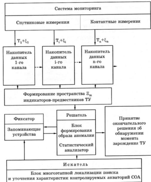
Рис. 1. Структурная схема организации мониторинговой системы поиска и обнаружения момента зарождения ТУ.
