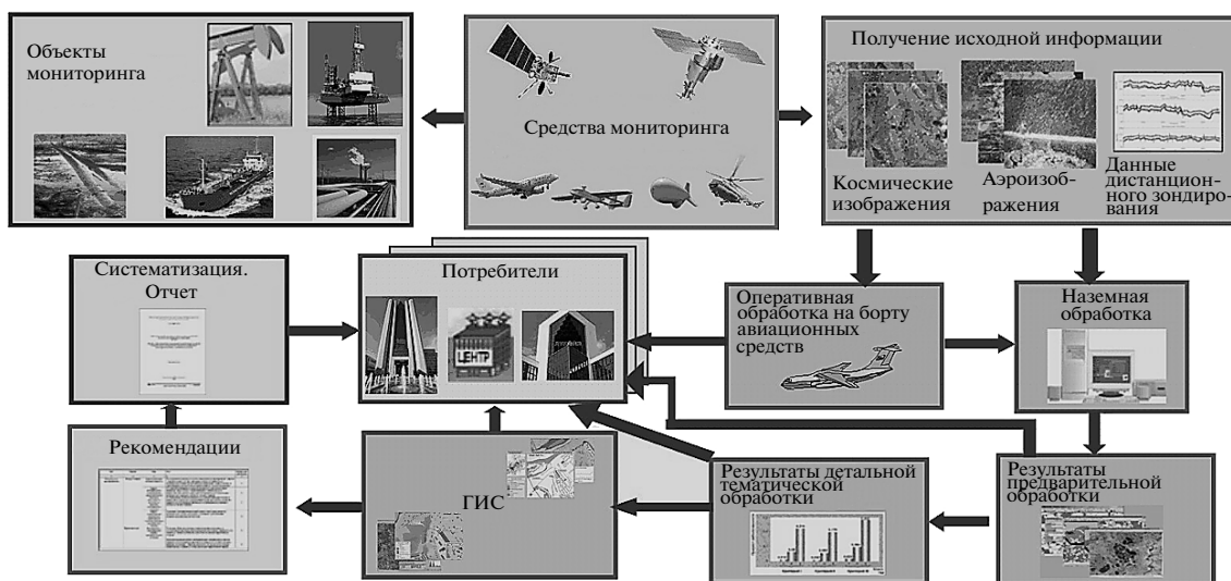
Рис. 2. Структурная схема формирования информационных продуктов в процессе аэрокосмического мониторинга нефтегазоносных территорий и объектов нефтегазового комплекса.
