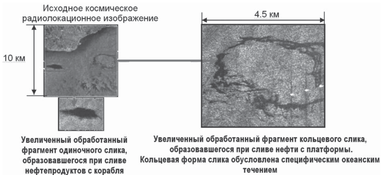
Рис. 4.3.6. Пример космических радиолокационных изображений с проявлением нефтяных загрязнений, приуроченных к нефтедобывающим платформам и судам (побережье в районе г. Санта-Барбара, США) (Бондур, 2004)
