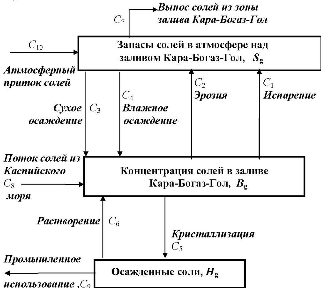
Рис. 3.12. Принципиальная схема потоков соли в зоне влияния залива Кара-Богаз Гол
