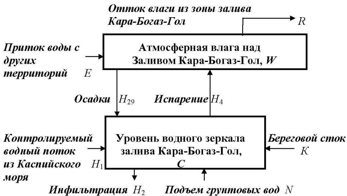
Рис. 3.14 . Принципиальная схема водных потоков в зоне влияния зал. Кара-Богаз-Гол.
