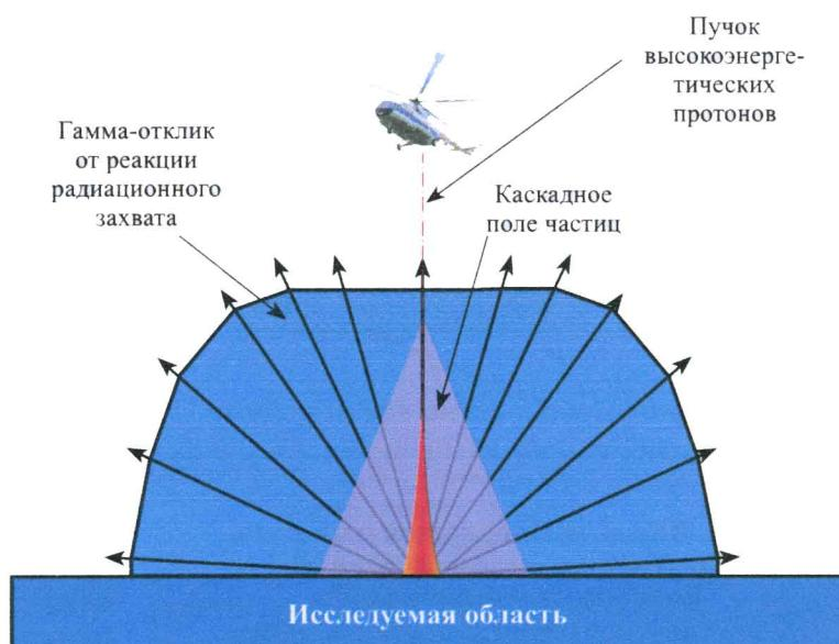
Рис. 1. Предварительная схема практической реализации активного метода дистанционной георазведки с использованием протонного ускорителя
